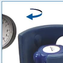
2. Fermez la vanne de la bouteille de CO<sub>2</sub>. Ouvrez les fenêtres et les portes et aérez complètement la pièce.
