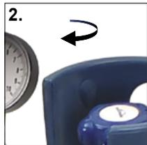
2. Cierre la válvula del cilindro de CO<sub>2</sub>.
